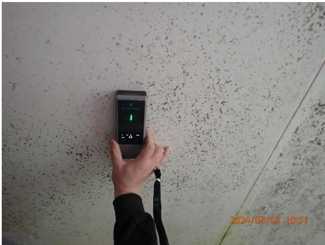
Nuotrauka Nr. 25. Gelžbetoninės plokštės skenavimas armavimo vietų nustatymui
