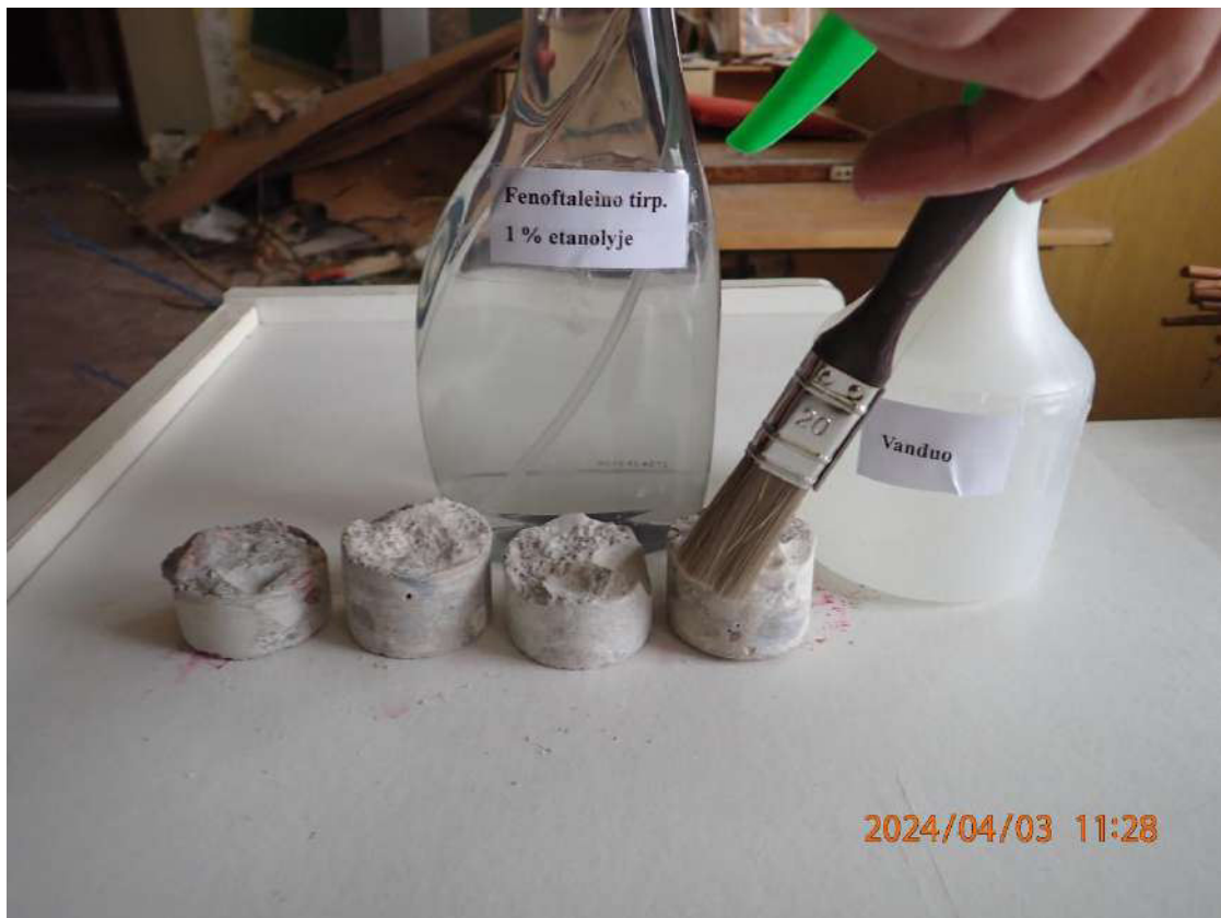
Nuotrauka Nr. 29. Perdangos plokštės betono kernų (ėminių) paruošimas tyrimams
