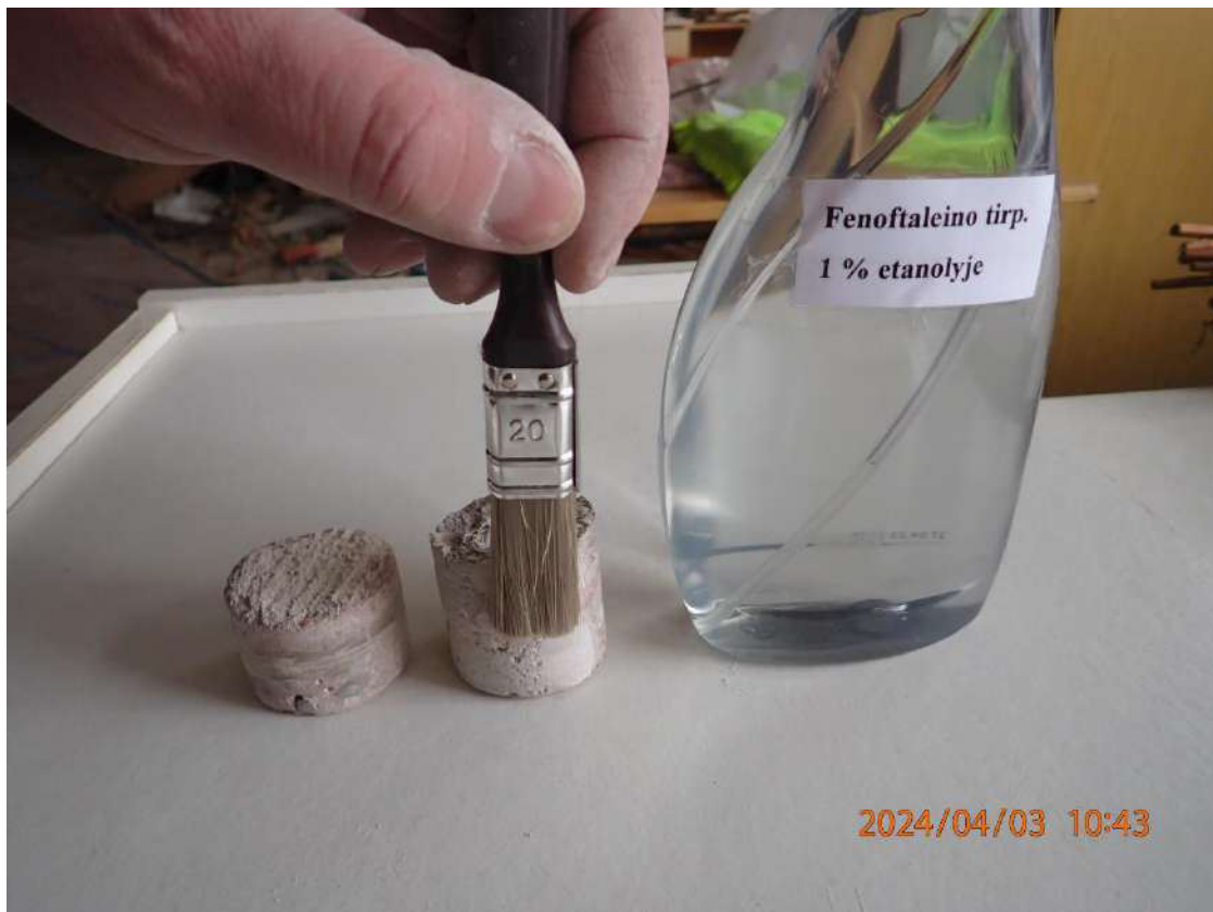
Nuotrauka Nr. 23. Denginio plokštės betono kernų (ėminių) paruošimas tyrimams
